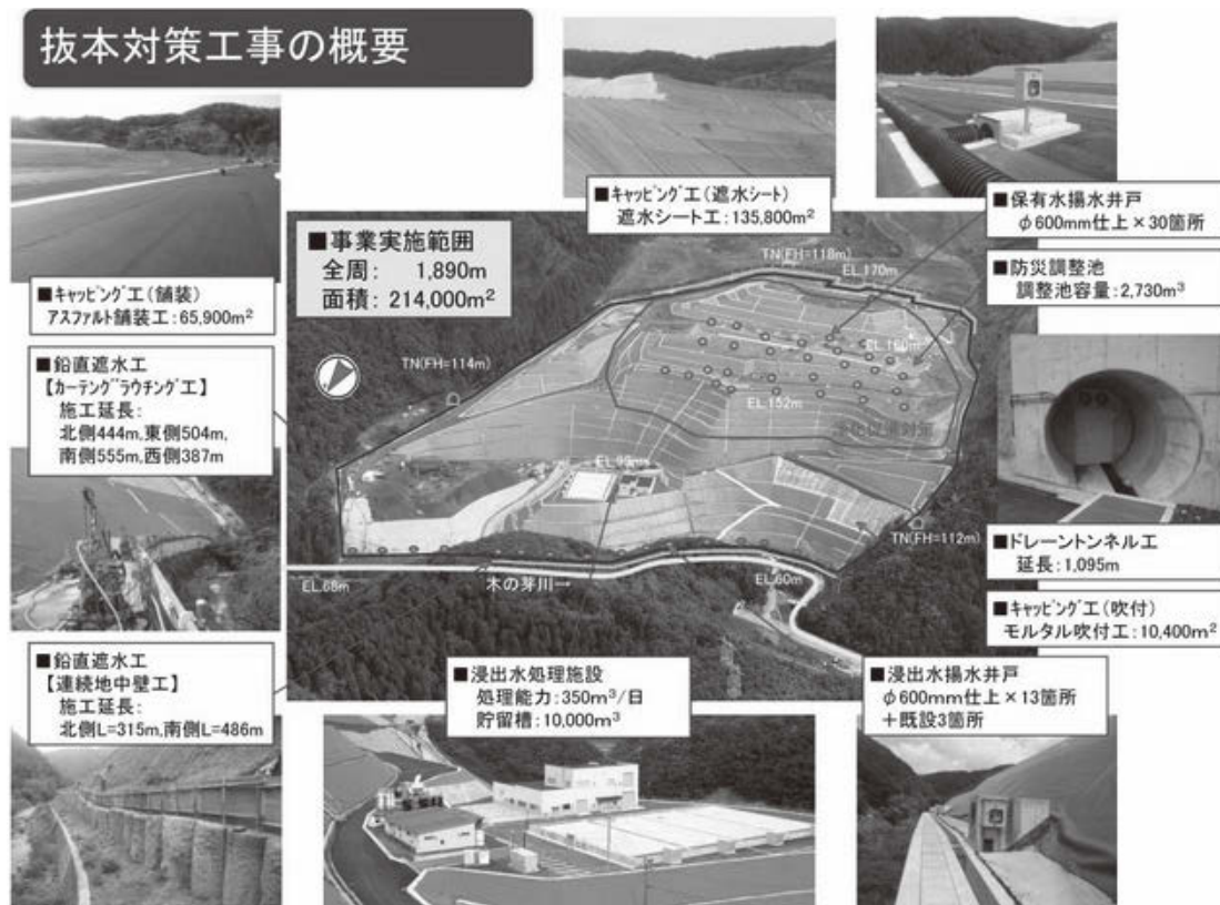
図2 本件抜本対策措置
